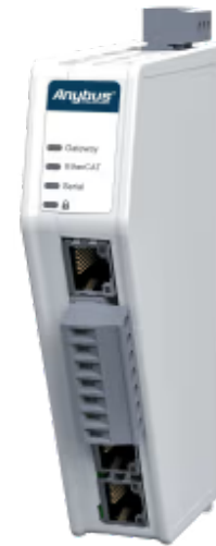
Protokollkonverter zur Anbindung serieller Geräte an EtherCAT-Steuerungen
