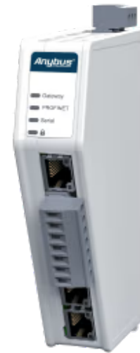
Protokollkonverter zur Anbindung serieller Geräte an PROFINET-Steuerungssysteme
