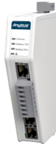
Ein Protokollkonverter zur Verbindung von Modbus-RTU- und Modbus-TCP-Steuerungen
