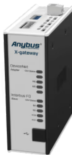
Ein Protokollkonverter zur Verbindung von DeviceNet- und Interbus-LWL-Steuerungen
