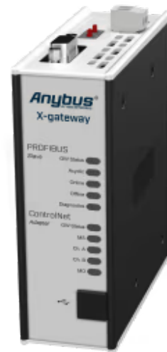
Protokollkonverter zur Verbindung von ControlNet- und PROFIBUS-Steuerungen
