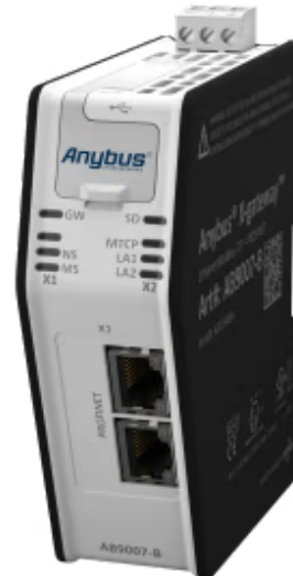
Ein Protokollkonverter, der Modbus-TCP-Geräte mit PROFINET-IO-SPSen verbindet
