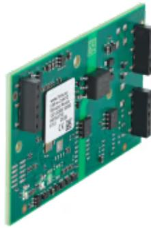
PC-Schnittstellenadapter (2x CAN FD), galv. isoliert
