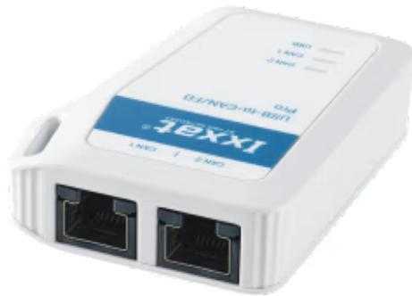
PC-Schnittstellenadapter (2x CAN FD), galv. isoliert
