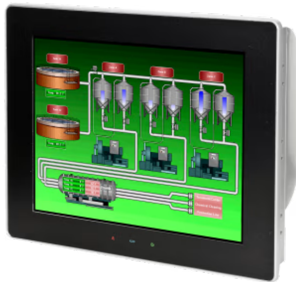
全铝结构，配备高分辨率 HMI 面板及双以太网端口
