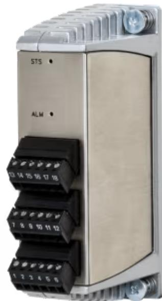
可靠、多功能的PID控制模块，用于Graphite®产品的加热器监控
