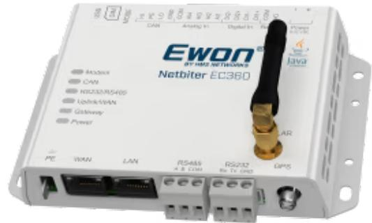
*Remote-Kommunikationsgateway für den Datenaustausch über Cellular 4G oder Ethernet mit der Netbiter Argos IIoT-Plattform*
