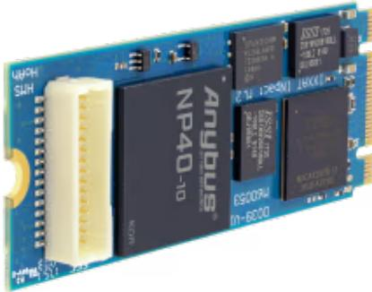
Ixxat INpact PIR Slave M.2是一种多功能、高效的解决方案，可将嵌入式系统和PC连接到PROFINET IRT网络。这种预配置的PROFINET IRT型号具有非常节省空间的M.2格式，可提供精确的等时实时数据交换，非常适合运动控制和同步任务。
