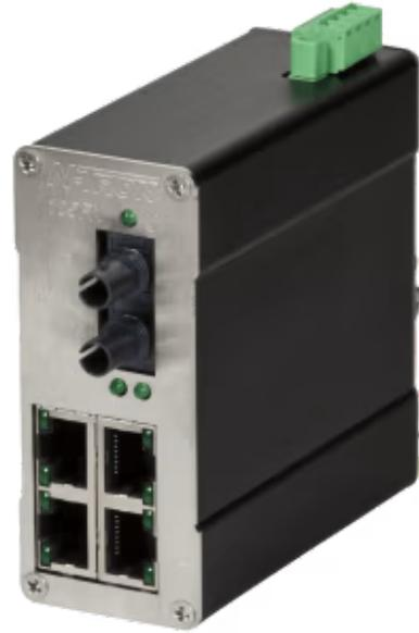
*Unmanaged 5-Port Industrial Ethernet-Switch mit Kupfer- und Glasfaseranschluss*
