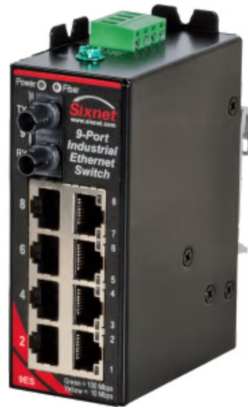
*Plug-and-Play 9-Port unmanaged Ethernet-Switch für Echtzeitbetrieb*
