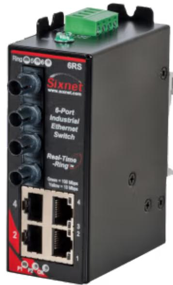
*Hochgeschwindigkeits-Managed-Ethernet-Switch mit 6 Ports für industrielle Konnektivität*
