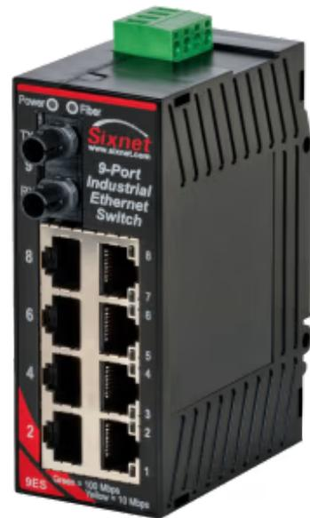
*Plug-and-Play 9-Port unmanaged Ethernet-Switch für
