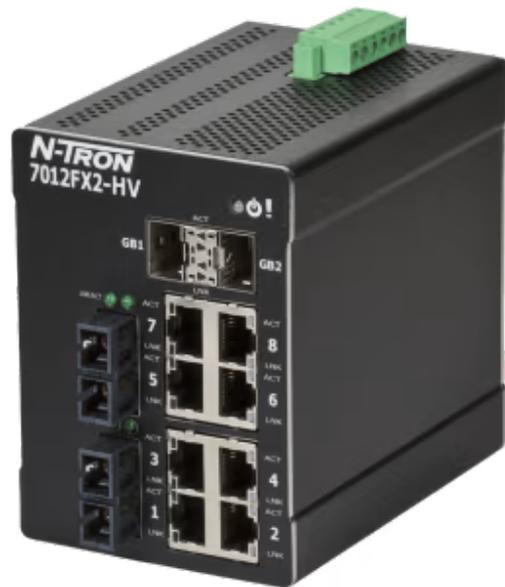
*High-Performance 12-Port Managed-Ethernet-Switch für industrielle Konnektivität mit Gigabit-Uplink-Ports*
