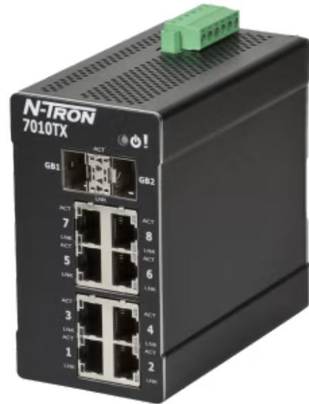
*High-Performance 10-Port Managed-Ethernet-Switch für industrielle Konnektivität mit Gigabit-Uplink-Ports*
