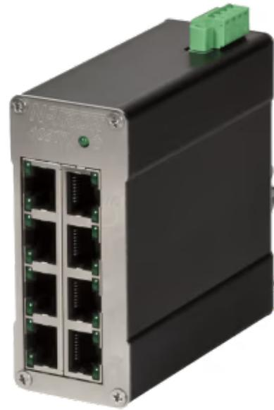
*Unmanaged 8-Port Industrial Ethernet-Switch mit Kupferanschluss*
