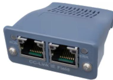
*Ermöglicht Automatisierungsgeräten die Kommunikation mit CC-Link IE Field-Netzwerken*
