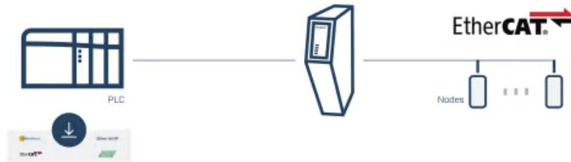
Der Communicator kann überall dort eingesetzt werden, wo Daten zwischen Steuerungssystemen mit unterschiedlichen Industrieprotokollen übertragen werden müssen.
