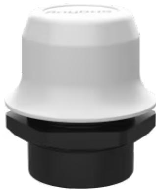
Der Anybus Wireless Bolt IoT ist ein industrietauglicher Router, der sowohl stationären als auch mobilen Industriemaschinen einen stromsparenden Internetzugang mit geringer Bandbreite bietet. Durch die Nutzung der 4G-LTE-Standards NB-IoT und CAT-M1 sowie mit 2G (GPRS/EDGE)-Fallback kann er weltweit eingesetzt werden.
