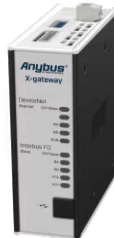
*Ein Protokollkonverter, der DeviceNet-Geräte mit Interbus-LWL-SPSen verbindet*
