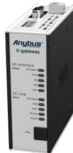
Ein Protokollkonverter, der AS-Interface-Geräte mit CC-Link-SPSen verbindet
