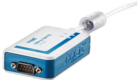
PC-Schnittstellenadapter (1 x CAN FD), galv. isoliert
