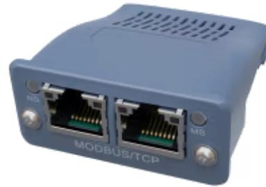
*Ermöglicht Automatisierungsgeräten die Kommunikation mit Modbus-TCP-Netzwerken*
