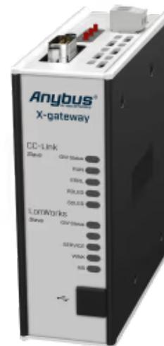
*Ein Protokollkonverter, der CC-Link- und Lonworks-Steuerungssysteme verbindet*
