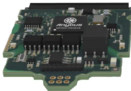
*Ermöglicht Automatisierungsgeräten die Kommunikation mit EtherNet/IP-Netzwerken*
