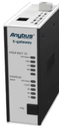
Protokollkonverter zur Verbindung von Interbus CU- und PROFINET-IO-Steuerungen
