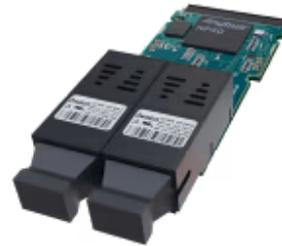
*Ermöglicht Automatisierungsgeräten die Kommunikation mit PROFINET-Glasfasernetzwerken*
