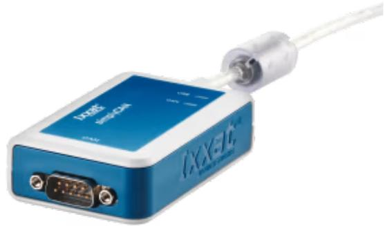
*CAN-USB-PC-Schnittstellenadapter (1 x CAN), galvanisch getrennt*
