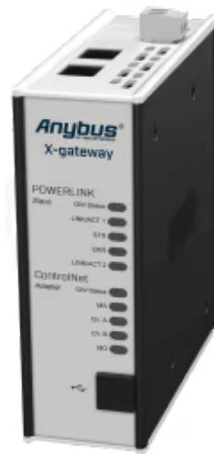
Protokollkonverter zur Verbindung von ControlNet- und POWERLINK-Steuerungssystemen
