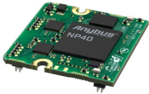
*Ermöglicht Automatisierungsgeräten die Kommunikation mit EtherNet/IP und IloT-Protokollen*
