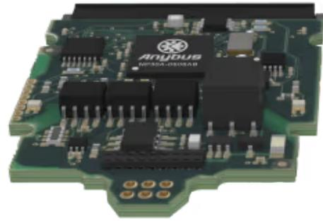
*Ermöglicht Automatisierungsgeräten die Kommunikation mit Modbus-TCP-Netzwerken*
