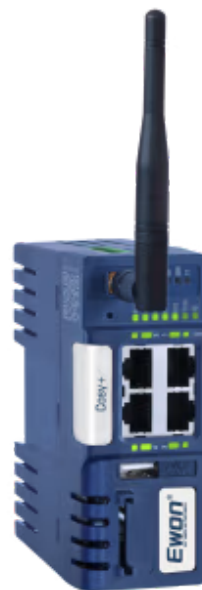
工业 VPN 网关，用于安全远程访问机器
