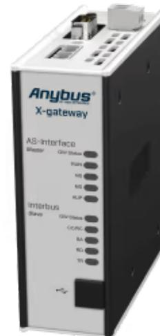
*Ein Protokollkonverter, der AS-Interface-Geräte mit Interbus-CU-SPSen verbindet*
