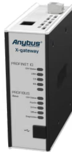
Protokollkonverter zur Verbindung von PROFINET IO- und PROFIBUS DP-V0-Steuerungen
