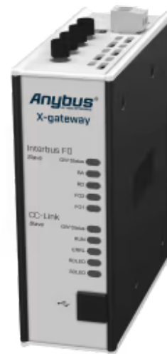
Ein Protokollkonverter zur Verbindung von CC-Link- und Interbus-LWL-Steuerungen
