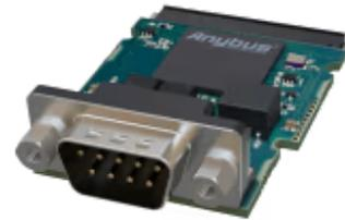
*Ermöglicht die Kommunikation zwischen Automatisierungsgeräten und CANopen-Netzwerken.*
