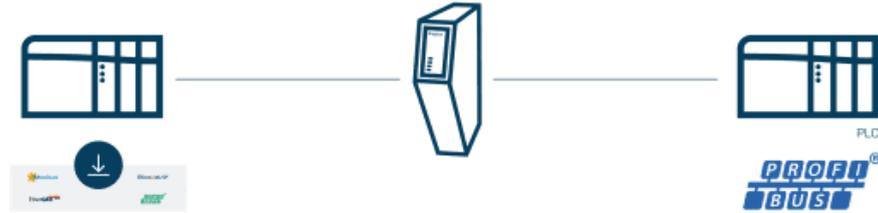
Der Communicator kann überall dort eingesetzt werden, wo Daten zwischen Steuerungssystemen mit unterschiedlichen Industrieprotokollen übertragen werden müssen.
