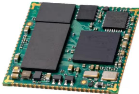
*Embedded SoC Controller für IEC 61131-3 Laufzeitsystem*
