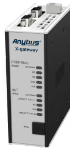
连接PROFIBUS和OPC UA-MQTT信息系统的协议转换器
