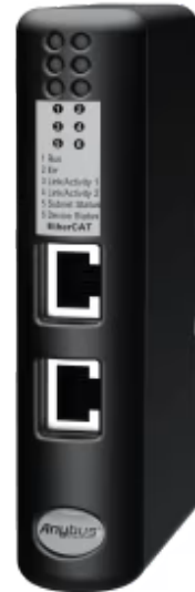
Ein Protokollkonverter, der CANopen-Geräte mit EtherCAT-SPSen verbindet
