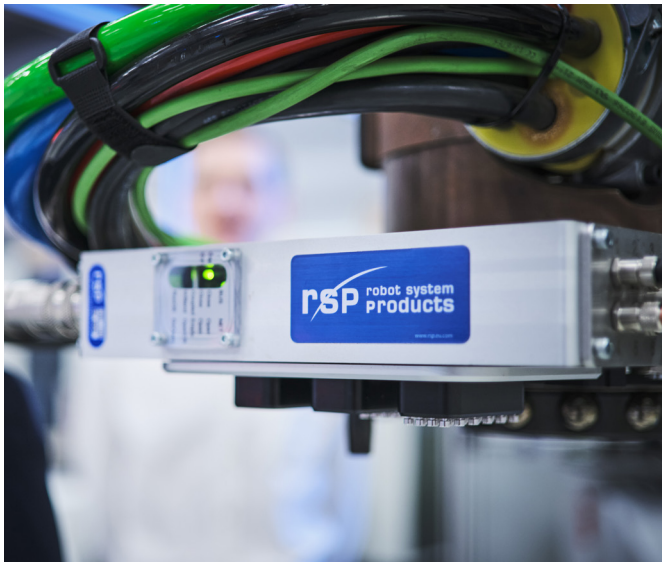
图1: Moduflex工具更换器安装在机器人上, 使机器人能够快速、安全地
