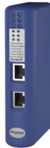
*Ein Protokollkonverter, der CAN-Geräte mit EtherNet/IP-Steuerungssystemen verbindet.*
