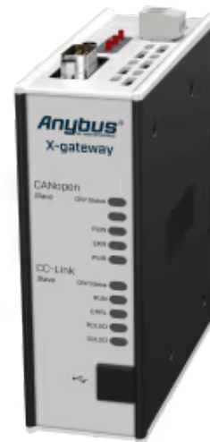
Protokollkonverter zur Verbindung von CANopen- und CC-Link-Steuerungen
