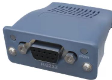
*Ermöglicht transparente RS-232-Kommunikation*
