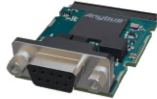
*Ermöglicht transparente RS-485/422-Kommunikation*
