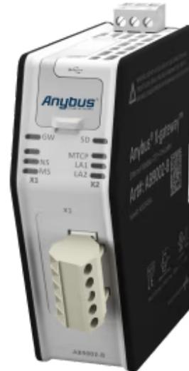
Ein Protokollkonverter, der Modbus-TCP-Geräte mit DeviceNet-SPSen verbindet
