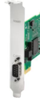
用于CAN (1 x CAN) 的PC接口卡，电气隔离
